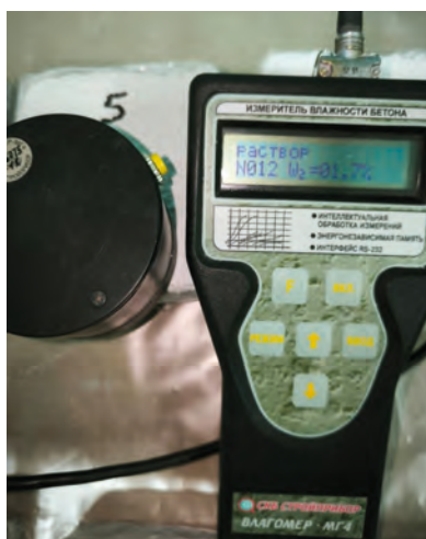
Рис. 6. Измерение влажности поверхности штукатурного покрытия исследуемых образцов влагомером-МГ4
