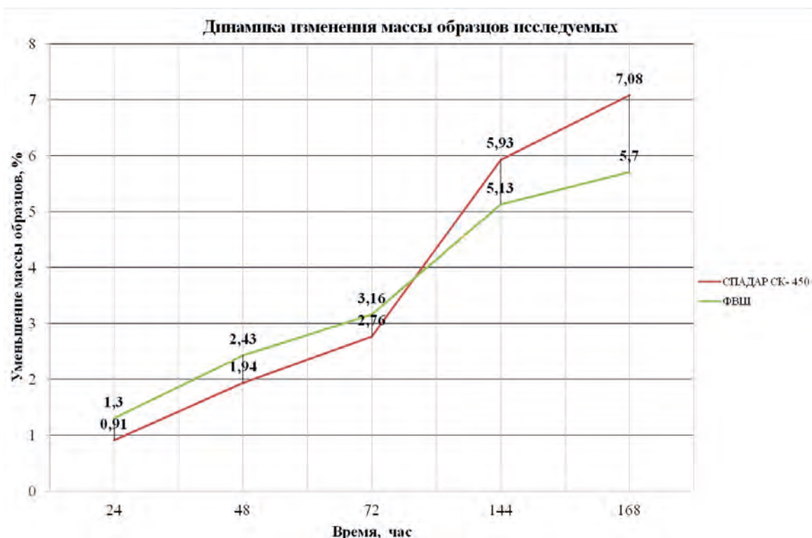
Рис. 7. График уменьшения средней массы исследуемых образцов в течение анализируемого периода времени Fig. 7. A graph of the decrease in the average mass of the studied samples during the analyzed time period
