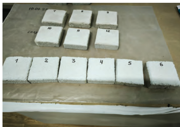
Рис. 2. Фото образцов газобетона, покрытых слоем исследуемых штукатурных смесей Fig. 2. Photos of aerated concrete samples covered with a layer of the studied plaster mixtures
