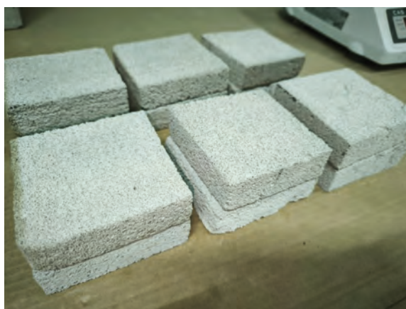
Рис. 1. Фото образцов газобетона, выпиленных из блока Fig. 1. Photos of aerated concrete samples cut from the block
