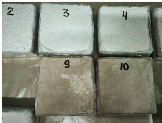
Рис. 9. Фото исследуемых образцов. Сверху образцы со штукатуркой «СПАДАР СК-450», снизу со штукатуркой ФВШ Fig. 9. Photos of the studied samples. Samples with SPADAR SK-450 plaster on top and FLP plaster on the bottom
