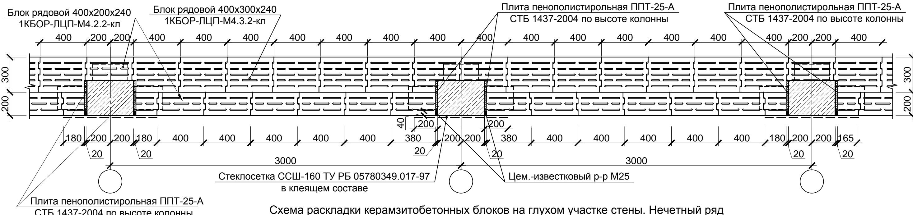
Схема раскладки керамзитобетонных блоков на глухом участке стены. Нечетный ряд
